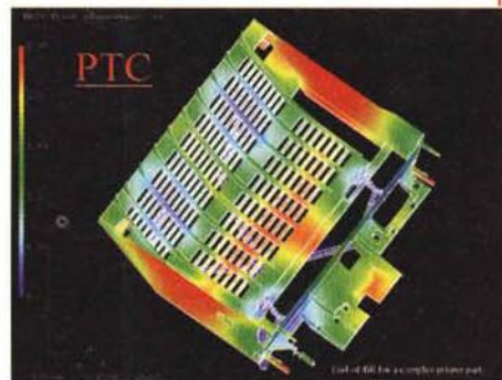
Processo di riempimento dello stampo di una parte dello chassis di una stampante.
